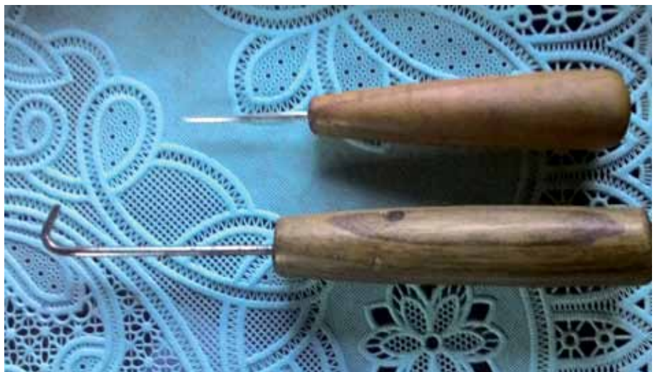
Gantol und Tuncek, zwei wichtige Werkzeuge für HeimarbeiterInnen, um Schuhe zu nähen, Foto: Dietrich Weinbrenner
